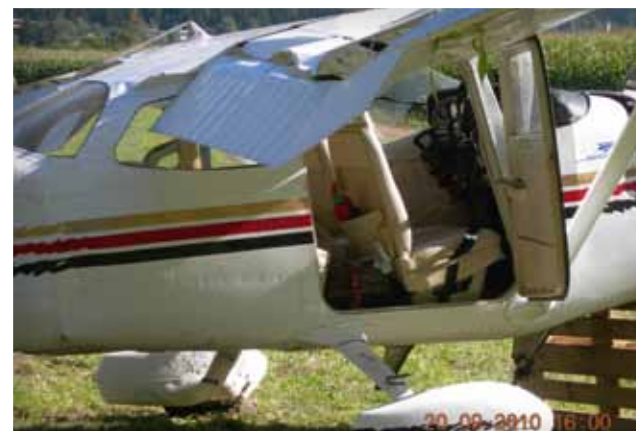
Der Boden zu feucht, die Maschine zu schwer - Fazit Crash Sand in Taufers Sept. 2010
